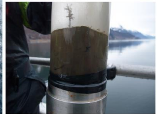
Figur 2. Kjerneprøvetaker og sedimentkjerne (Foto: NIVA)
